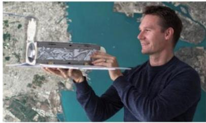
120 Nanosatélites llamados "Dove" (paloma). Compuestos por un cilindro de 30cm (formato "Cubesat") con una cámara dentro y dos paneles solares que se despliegan a los lados cuando están en órbita.
