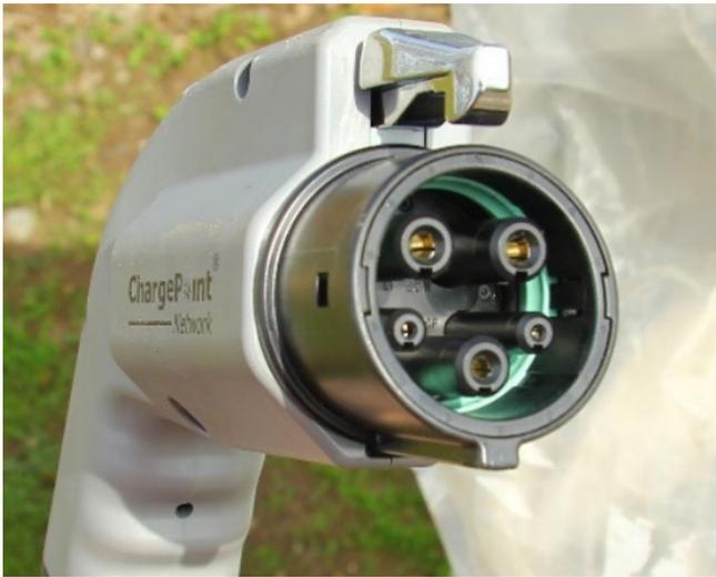
Figura 8: Conector IEC 62196 Tipo 1, Fuente: [8]
