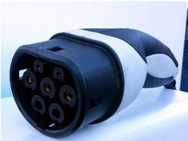
Figura 9: Conector IEC 62196 Tipo 2, Fuente: [8][8]
