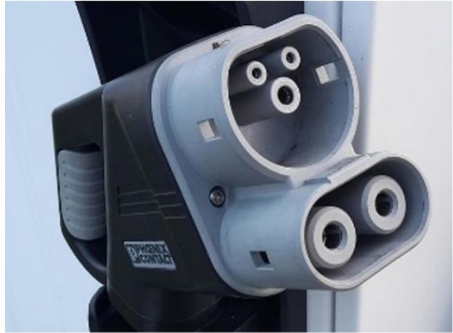
Figura 12: Conector CCS tipo 2, Fuente: [12][12]
