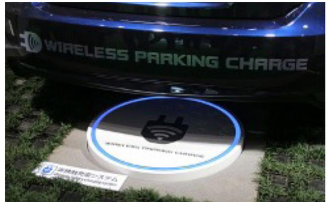
Figura 16: Plataforma de carga inalámbrica para vehículos eléctricos, Fuente: [26]
