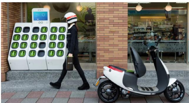
Figura 17: Estación manual de intercambio de baterías para e-scooters por Gogoro en Taiwán, Fuente: [30]
