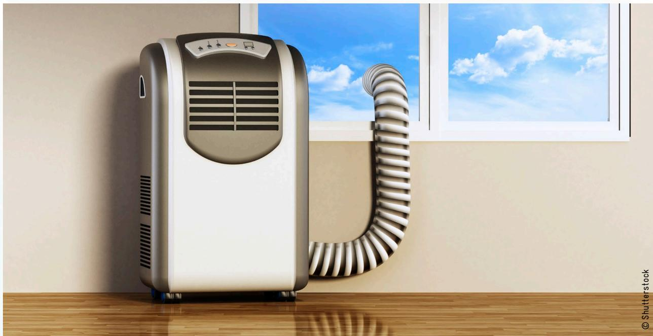
La capacidad de los AC portátiles oscila entre 6.000 BTU/h [1,75 kW] y 10.000 BTU/h [3 kW]. Como no se requiere ningún trabajo de instalación en el sitio, el circuito de refrigerante está sellado de fábrica y, por lo tanto, las emisiones durante el uso son muy bajas. Se usan comúnmente R410A y R32, y también se puede usar R290 según los estándares actuales. Las tecnologías de inverter e inverter dual están disponibles en AC portátiles.
